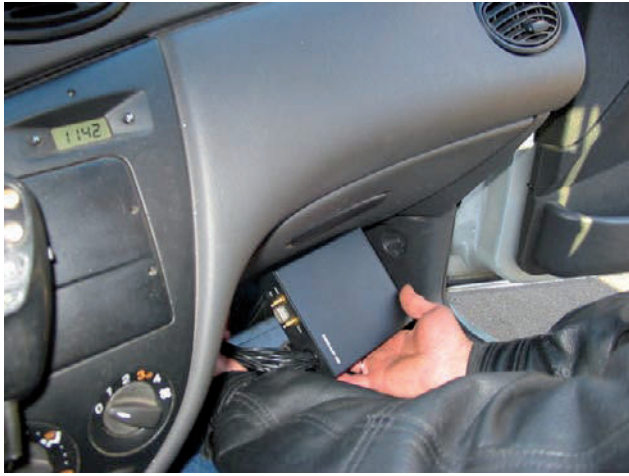
Монтаж навигационного устройства «Титан-10» в автомобиль
