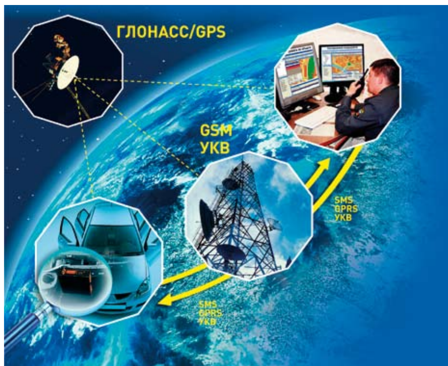
Принцип работы системы мониторинга объектов с приемником ГЛОНАСС/GPS
